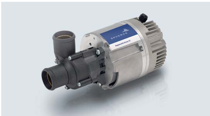
Aquavent 6000 SC: bürstenlose EC-Pumpe mit Magnetkupplung.
